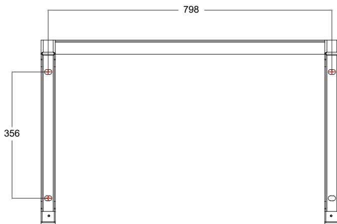
Рис. 4.4 Размеры монтажных кронштейнов
