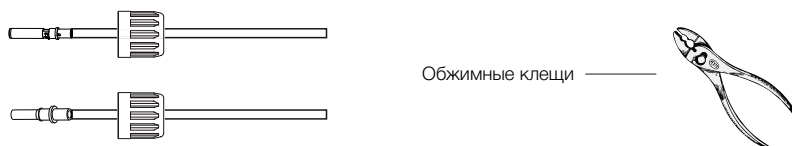
Рис. 5.4 Обжатие контактного вывода
