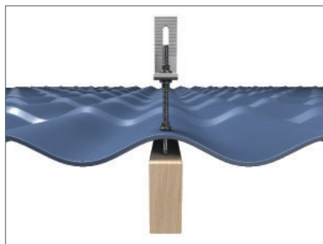
Рисунок 3.2.2 Схема установки кронштейна XMR-VI-02 на металлочерепицу или мягкую кровлю
