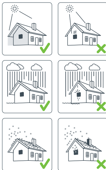
Рисунок 3.4.1 Правила расположения инвертора на фасаде здания
