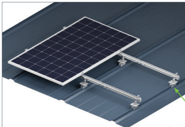
Рисунок 3.3.4 Способ крепления ФЭМ на фальцевую кровлю
